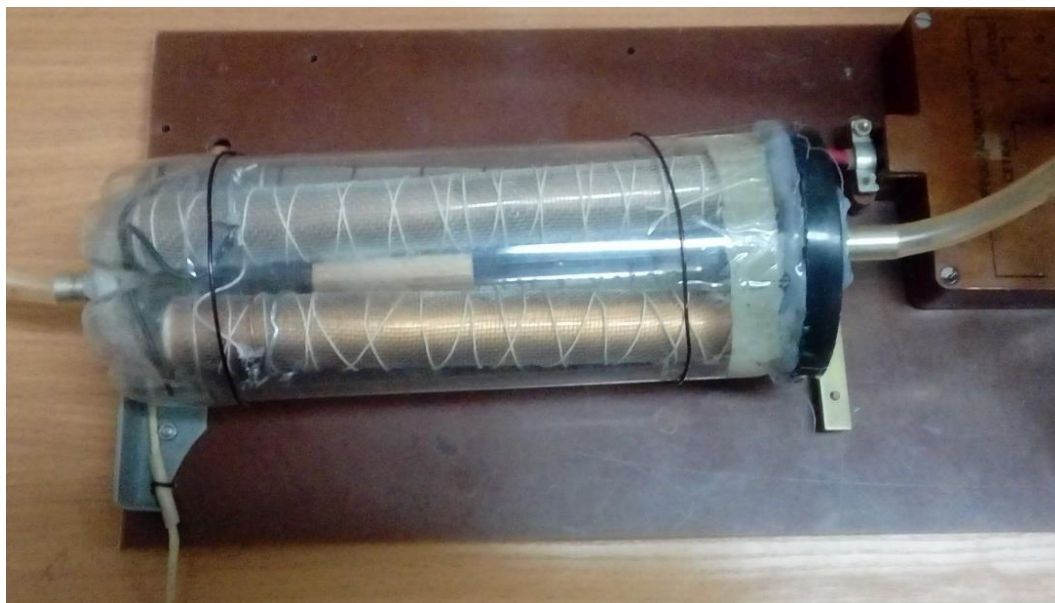
Рисунок 2 – Испытательный образец озонатора на коронно-барьерном разряде
