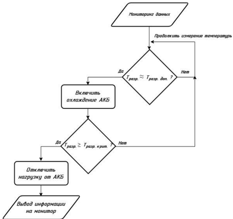
Рисунок 5 – Алгоритм контроля температуры при разряде АКБ
